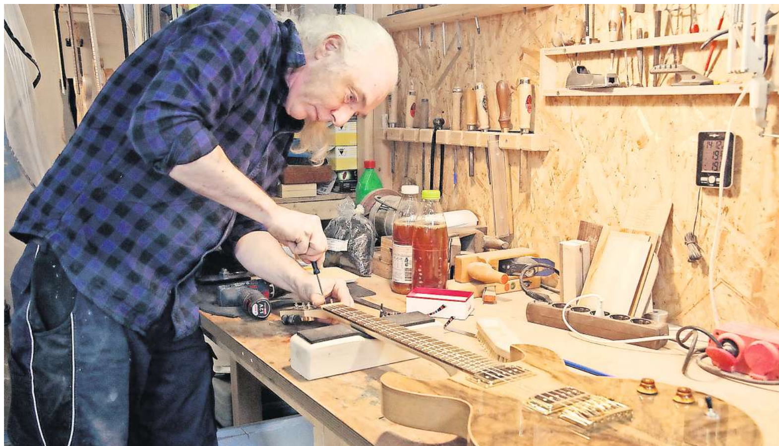
Nimmt hier die Feinjustierung der Halsneigung vor: Gitarrenbauer Henning Mohr.
